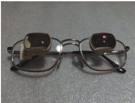
Telescopio galileo 2.2X afocal montado en gafa en posición superior
